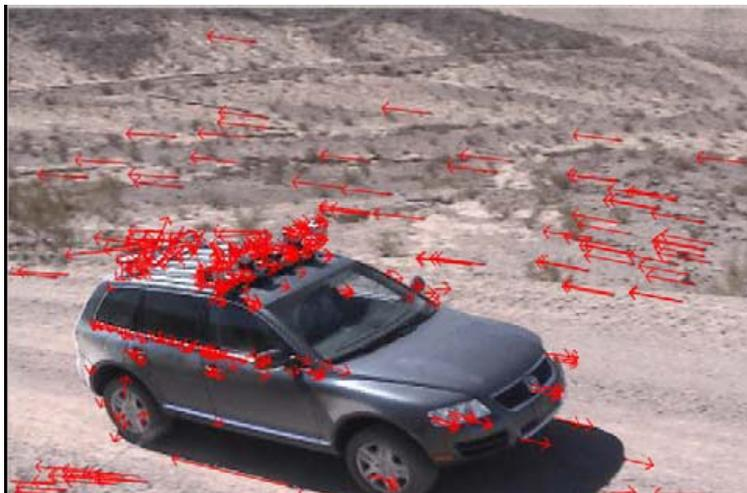
**Abb. 2.13:** *Optical-Flow*-Algorithmus bei der Verfolgung eines sich bewegenden Objekts [SD05]
