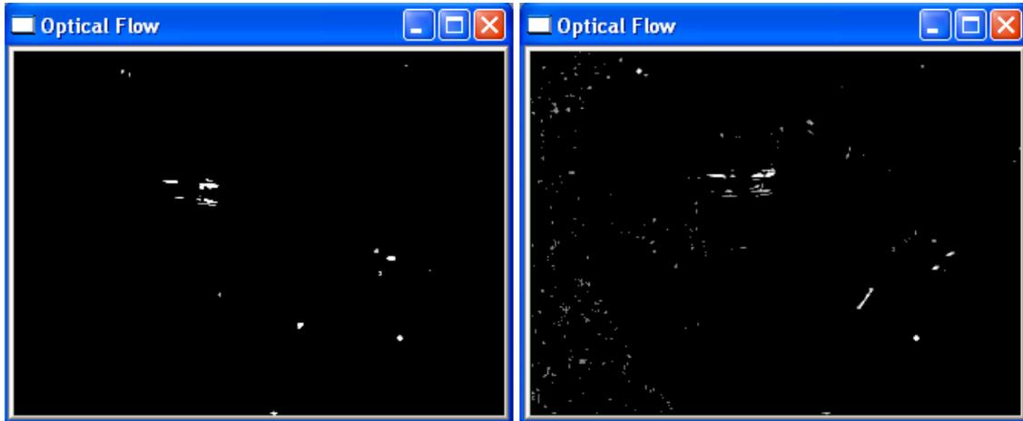
Abb. 7.1: Eigenwert-Bild ohne (links) und mit Schwarzfilter (rechts)
